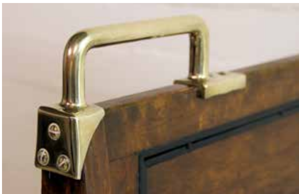
Messing handgreep, waarvan acht stuks werden nagegoten, evenals acht messing ankerplaten voor de Boedapester B 412.
