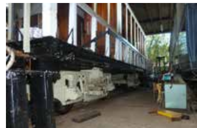
Motorrijtuig A 14 in 1956 volop in bedrijf. De draaistellen worden te Haarlem onder de rijtuigbak van de A 14 teruggeplaatst.
