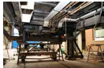
In de HTM-remise Lijsterbesstraat staat de A 106 opgebokt en werkt men aan het onderstel en de bekabeling van het rijtuig.
