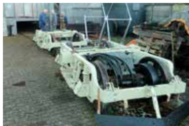
Motorrijtuig A 14 in 1956 volop in bedrijf. De draaistellen worden te Haarlem onder de rijtuigbak van de A 14 teruggeplaatst.
