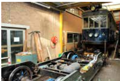
In de HTM-remise Lijsterbesstraat staat de A 106 opgebokt en werkt men aan het onderstel en de bekabeling van het rijtuig.
