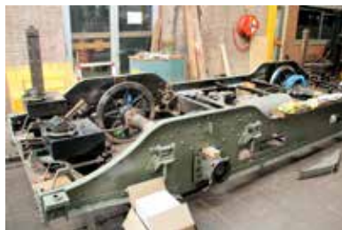
In de HTM-remise Lijsterbesstraat staat de A 106 opgebokt en werkt men aan het onderstel en de bekabeling van het rijtuig.
