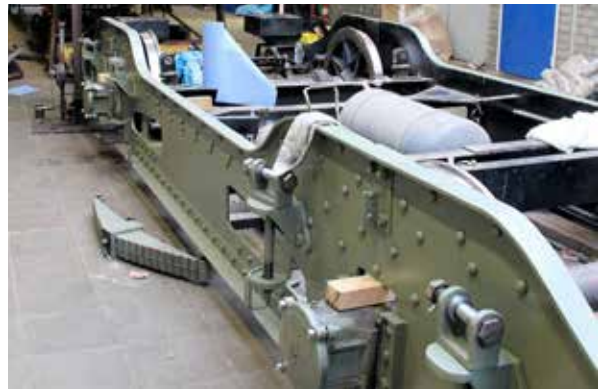
Werkzaamheden aan het onderstel en bladveren van de A 106.
