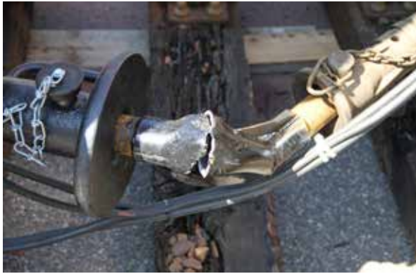
De koppeling die het bijna had laten afweten.
