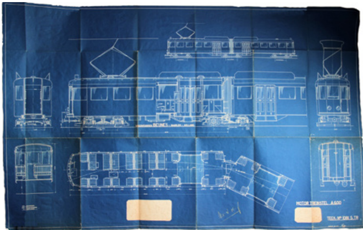
Beijnes blauwdruk uit 1932 van een Tweelingtramstel. De tekeningen uit ons archief, aangevuld met tekeningen afkomstig uit het Spoorwegmuseum, moeten het mogelijk maken de A 619/620 te reconstrueren.
