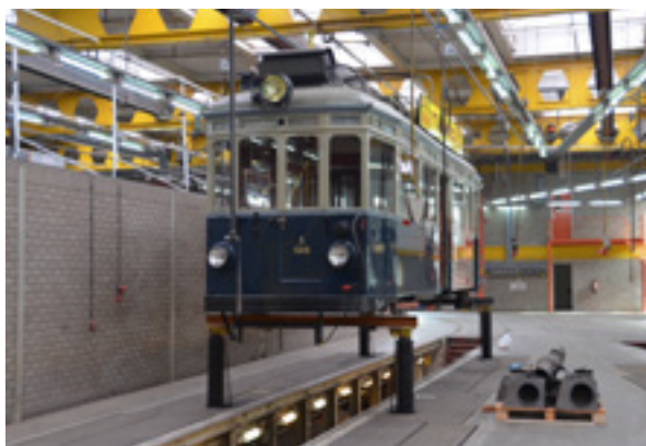
De op HTM-vijzels opgebokte A 106, remise Lijsterbesstraat.
