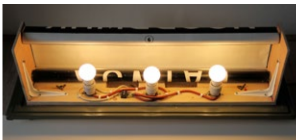
Interieur van de filmkast waarvan de bestemming handmatig kan worden voorgedraaid.
