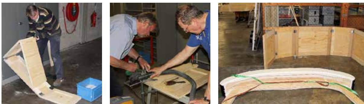
Lagere panelen zijn voorzien van scharnieren. Zaagwerk voor de juiste hoekverbindingen. De hogere panelen zijn bijna gereed.
