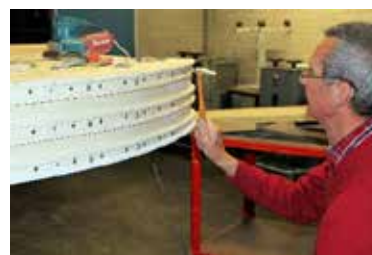
De basisplaat waarbij de ruitjes op formaat zijn aangebracht. De bufferbalk krijgt vorm. Johan Kres brengt de "klinknagels" aan.
