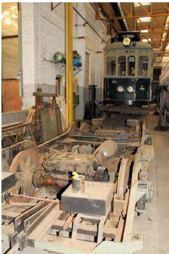
Onderstel van de A 106 is vrijgemaakt voor demontage.
