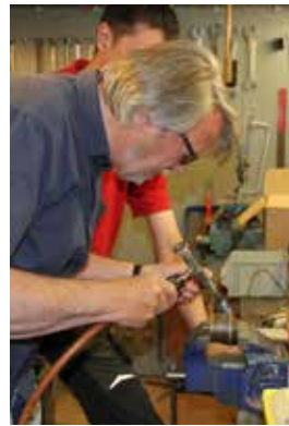
Hardsolderen en kabel weer vast op de veertrommel.
